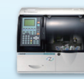
臨床化学分析装置 肝機能や腎機能、コレステロール、血糖などの測定に使用します
